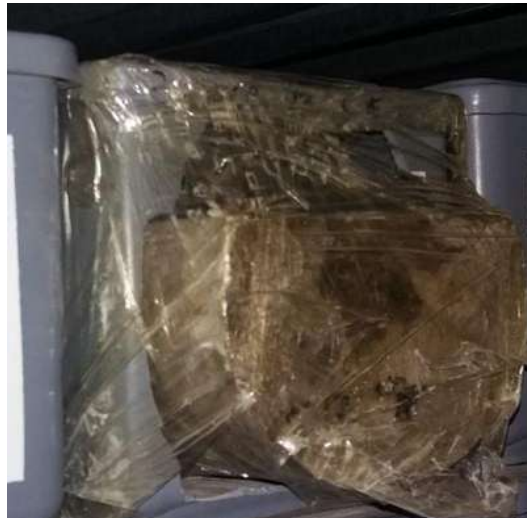
Figura 4 – Testemunho sob o efeito de expansão devido ao alto conteúdo natural de argilas expansivas (acervo pessoal)
