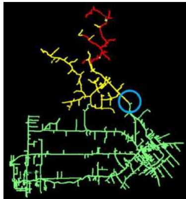
Figura 3 - Tensão nas barras: Cooperativa 2 (máximo), ano de 2019. Ponto onde os níveis de tensão começam a ficar precários (amarelo).
