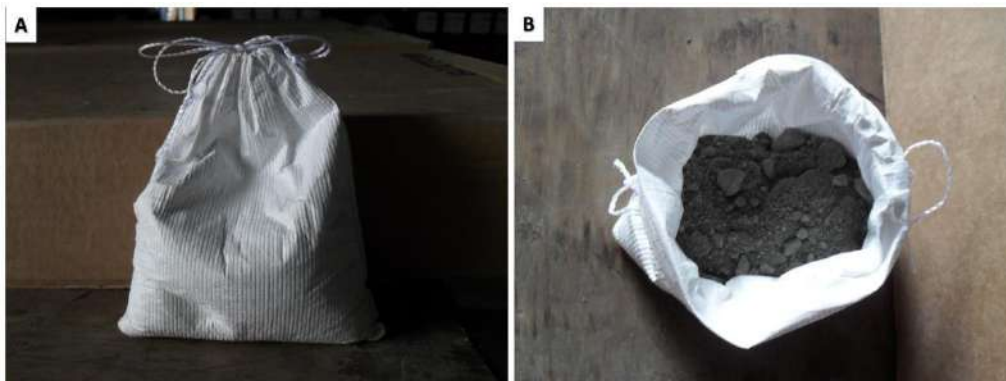
Figura 6 – Sacos tipo tyveck para acondicionamento de amostras de calha (acervo pessoal)
