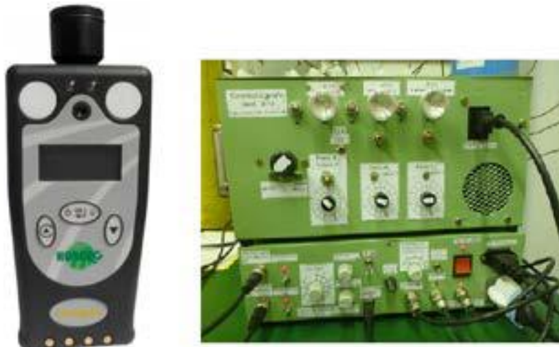
Figura 1 – Equipamentos odorímetro e cromatógrafo respectivamente para análise da concentração de odorante no gás
