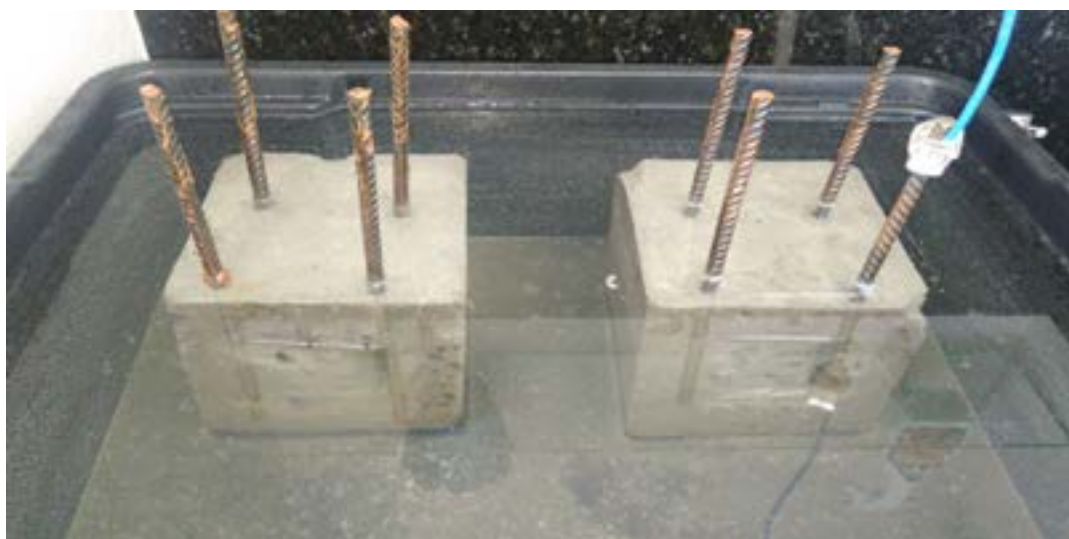
Imagem 04 - Corrosão do aço - importância do meio eletrólito
