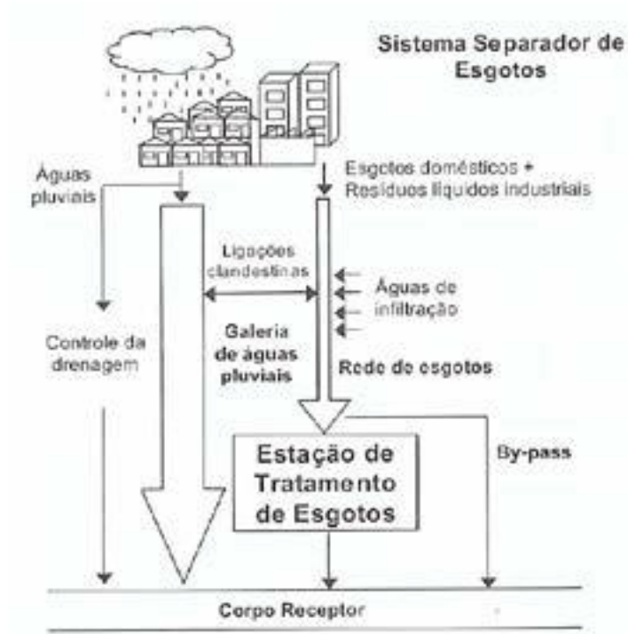
Figura 3 – Sistema Separador de Esgotos
