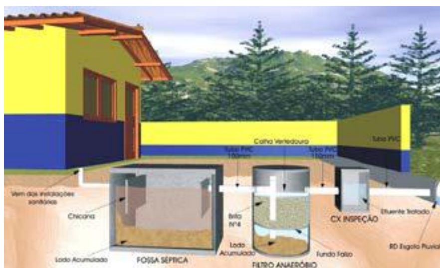
Figura 4 – Sistema Unitário de Esgotos
