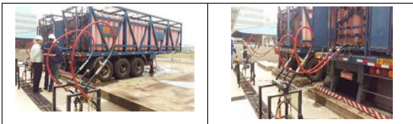
Figura 5 – Descompressão do GNC
