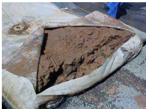
Figura 4: Lodo retido no BAG
