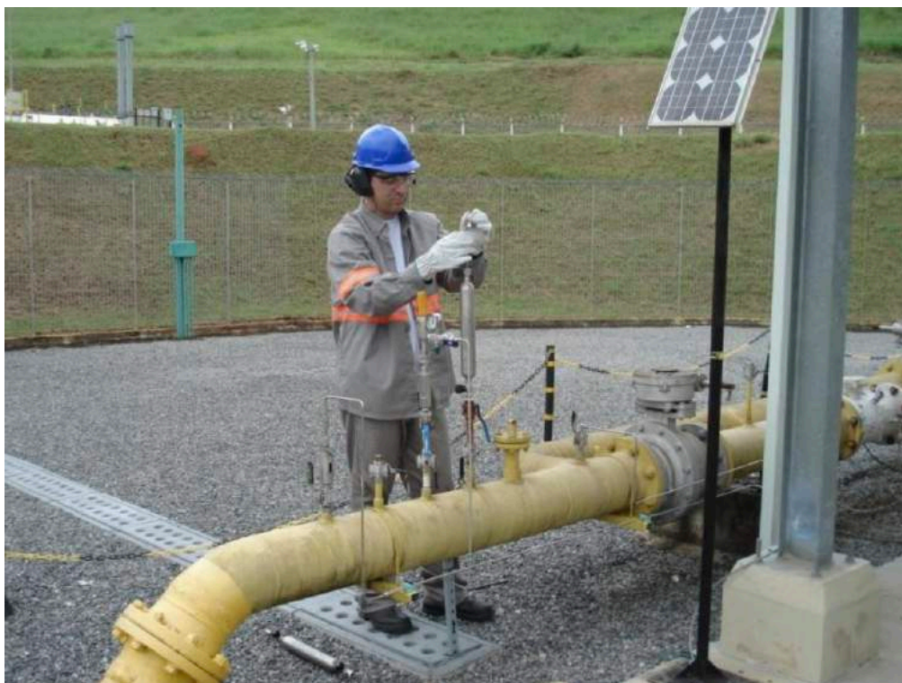
Figura 02 – Coleta de Amostra de Gás para Análise
