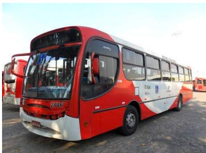
Figura 1 Ônibus convertido para 100% GNV da Viação Itajaí, rodando atualmente na cidade de Campinas/SP (fonte:arquivo pessoal)
