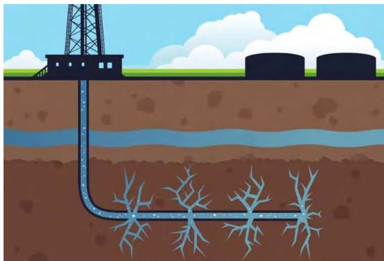
Figura 1 - Ilustração da técnica de fraturamento hidráulico
