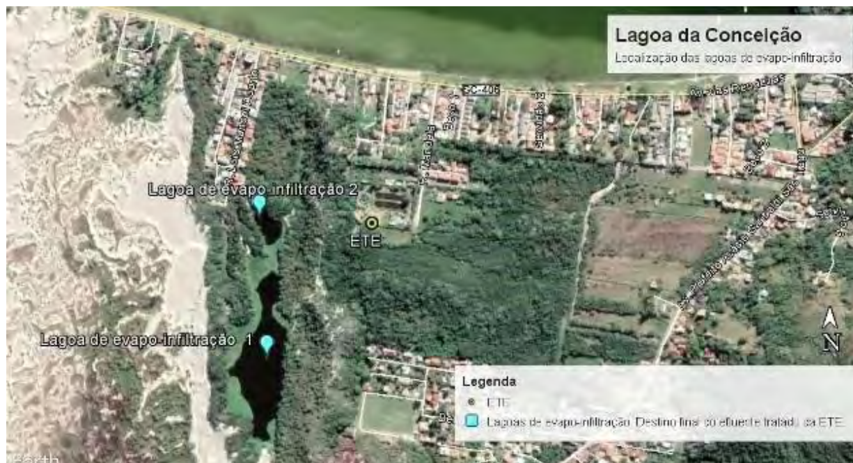
Figura 2 - Localização ETE Lagoa e Lagoa evapoinfiltração.
