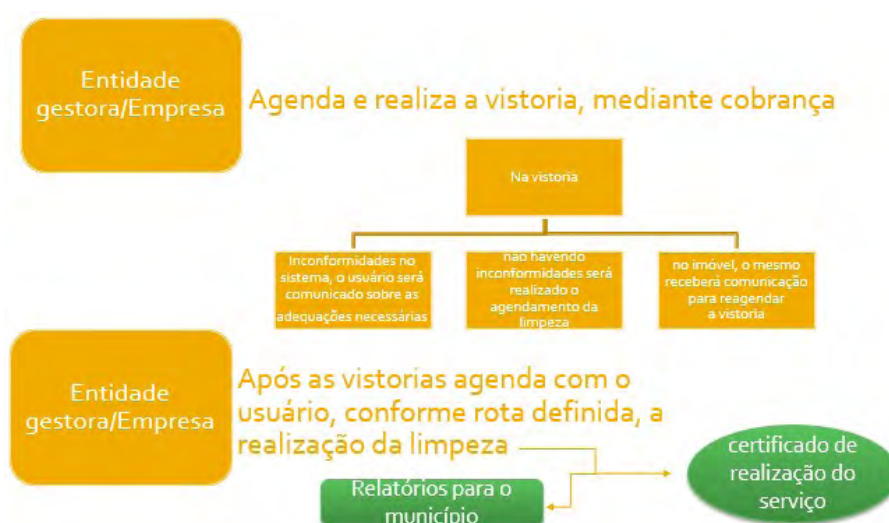
Figura 4 - Procedimento para a prestação do serviço de manutenção dos sistemas locais de esgotamento sanitário
