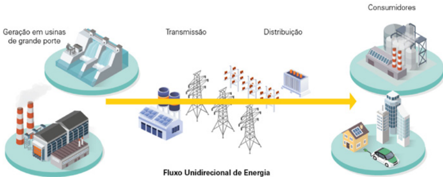
Figura 3 - Resumo da Rede Elétrica Tradicional
